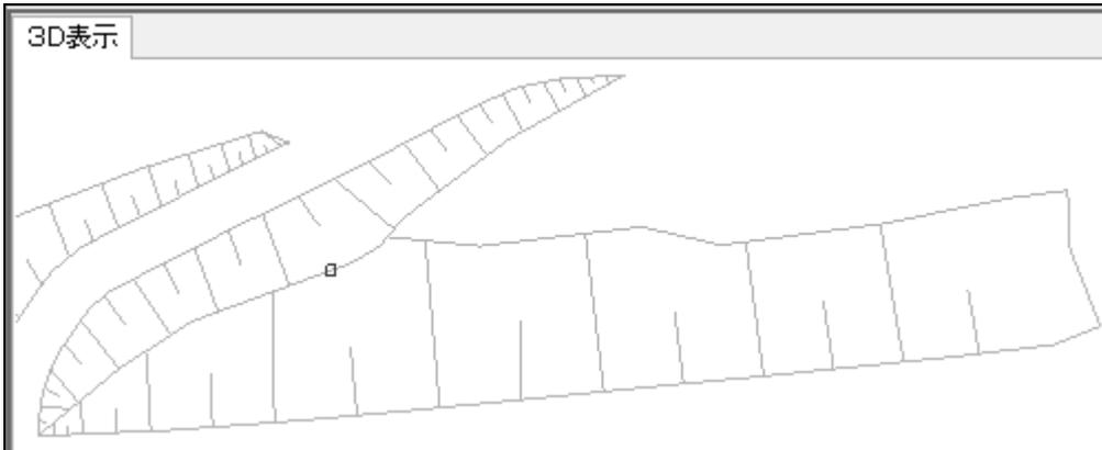
上図は削除前、下図は削除後の画面です。人口斜面の射影部の下端線について、重複している部分の両方が消えています。
