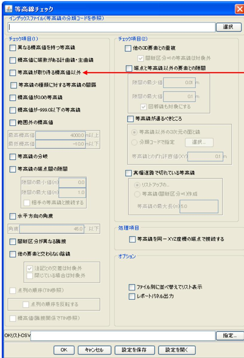
【等高線が取り得る標高地以外】等高線の種類（計曲線、主曲線、補助曲線、特殊補助曲線）に対して、それぞれとり得る標高値以外のケースを検出します。等高線の線(E2)の最初の点のZ値について、DMの地図情報レベルに応じて、下記の値の倍数以外の等高線をリストアップします。
